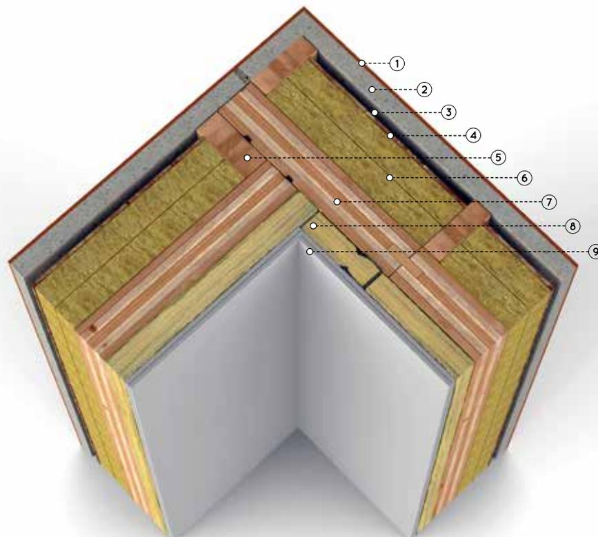
1\_Rasatura/Plaster 2\_Caldana in calcestruzzo/Concrete slab 3\_Camera d'aria ventilazione esterna/External open circuit air gap 4\_Pannello tecnico tipo OSB/OSB technical panel 5\_Isolante spessore variabile/Variable thickness insulation 6\_Travetti in legno/Timber beam 7\_Pannello X-lam/X-lam panel 8\_Isolante-spazio impianti/Insulation-installation cavity 9\_Cartongesso o fibrocemento/Plasterboard
